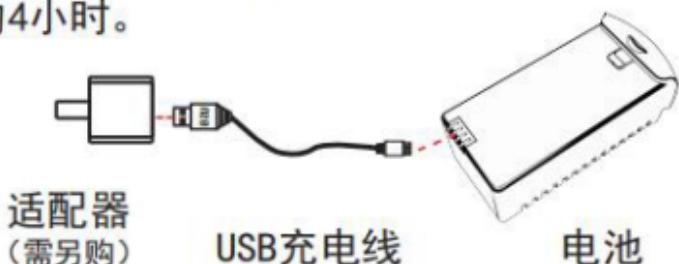
请尽量选用充电电流2A的适配器充电，可提升充电速度。
