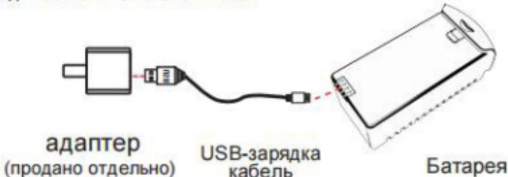
Пожалуйста, попробуйте использовать адаптер с зарядным током 2А для зарядки, который может улучшить скорость зарядки.
