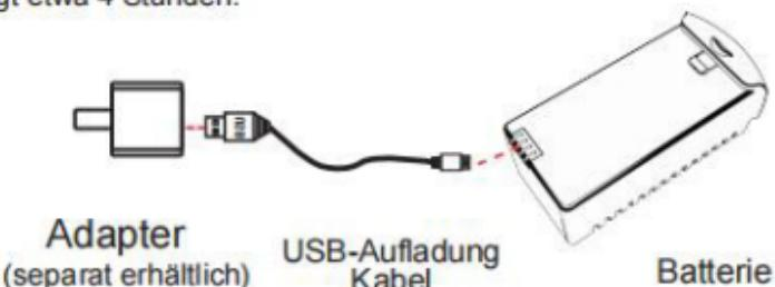
Bitte versuchen Sie zum Laden einen Adapter mit einem Ladestrom von 2A zu verwenden, der das kann die Ladegeschwindigkeit verbessern.
